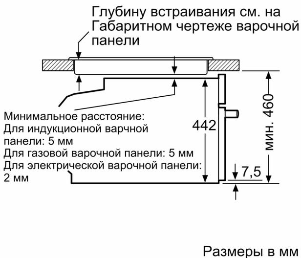
При встраивании мелких бытовых приборов под варочной панелью необходимо учитывать требования к толщине столешницы (включая усиливающий элемент).
