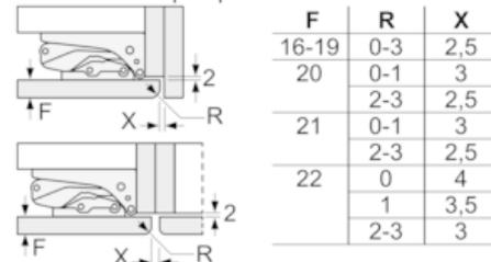
Рекомендуется соблюдать приведенные в таблице размеры зазора, чтобы обеспечить беспрепятственное открытие дверцы прибора и избежать повреждения кухонной мебели.
