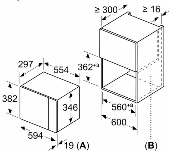
**A:** 20 мм при металлической фронтальной панели
