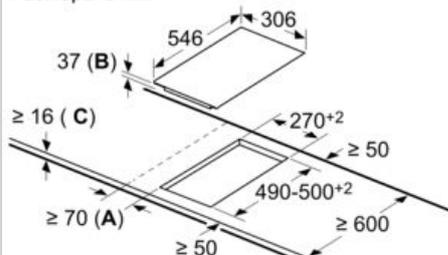
**A:** Минимальное расстояние от выреза для варочной панели до стены.
