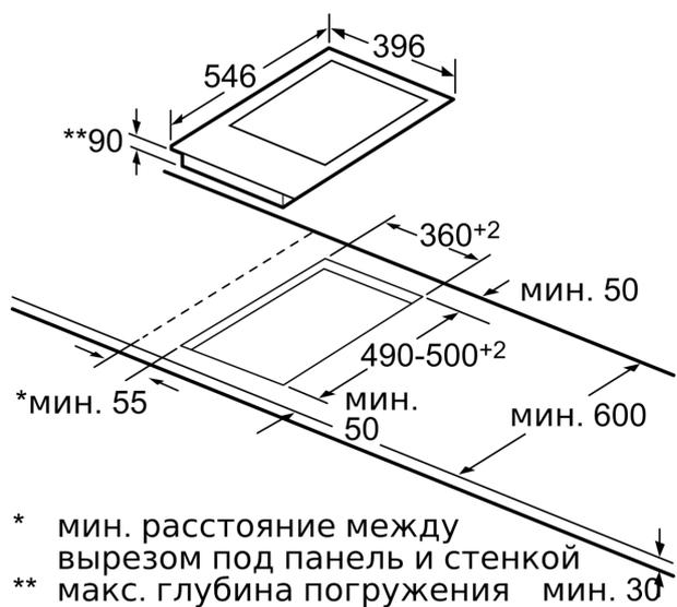
\* мин. расстояние между вырезом под панель и стенкой
