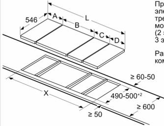
При установке двух или более элементов рядом друг с другом требуется один или несколько монтажных комплектов (2 элемента = 1 монтажный комплект; 3 элемента = 2 монтажных комплекта и т.д.).
